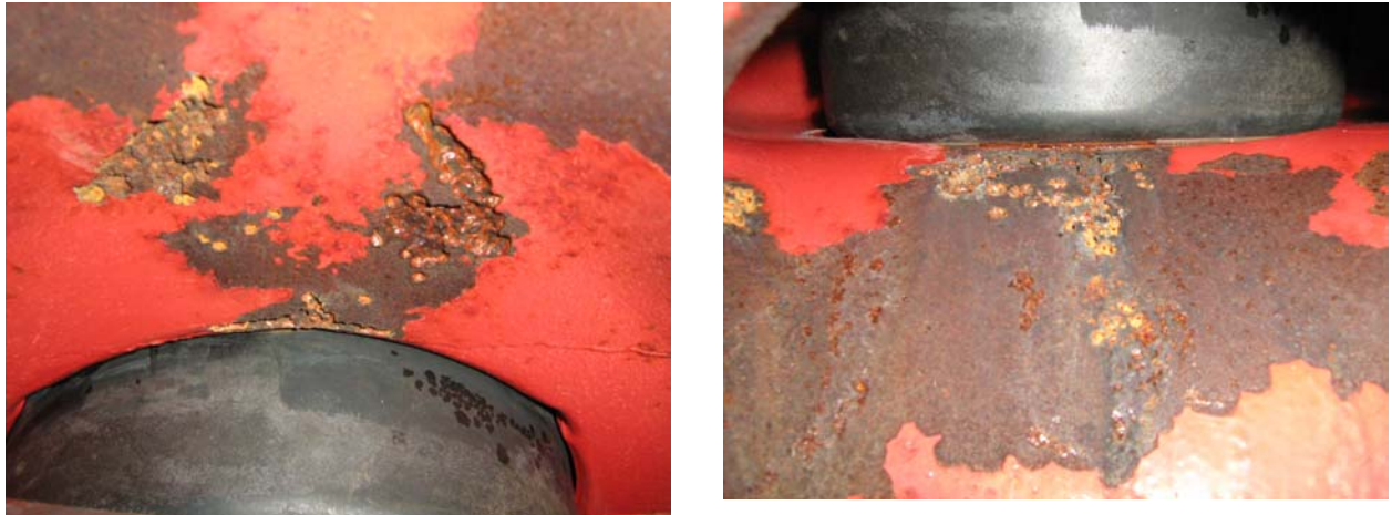
Figuur 5: Cavitatieschade PSV.
